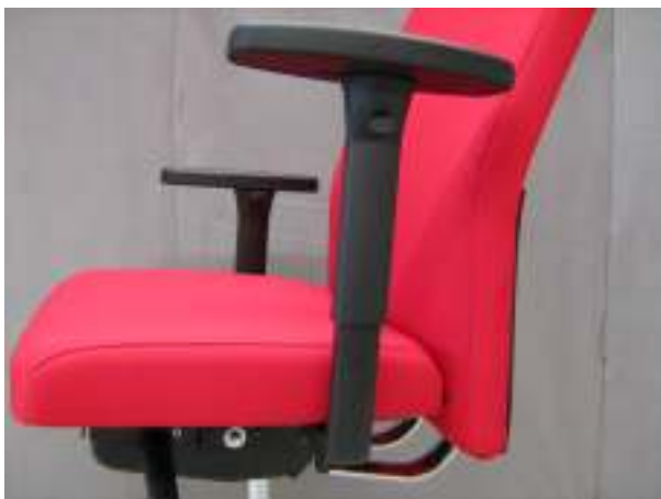
Figuur 7: Proefstuk 9268-2 - armsteun in laagste (achter) en hoogste (voor) stand
