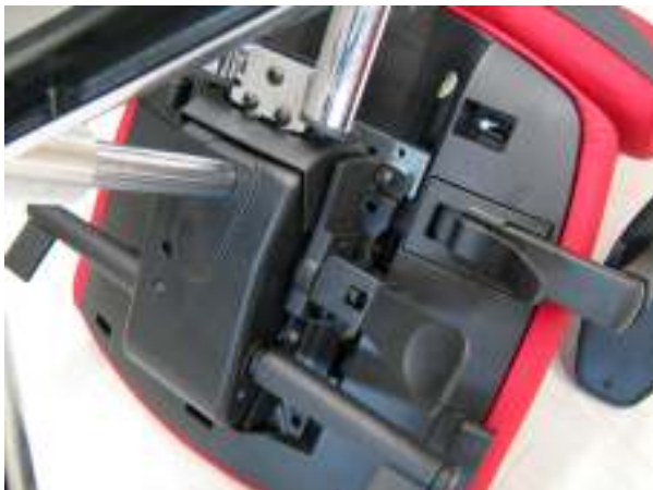
Figuur 11: Proefstuk 9268-2 - 9170-2 van Bèta kantoorstoel Laren - detail verstelmechanismen (4)
